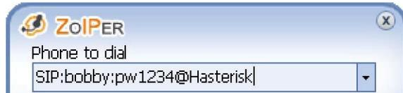
カーソルを“発信”項目に置き、名前と被発呼側のIPアドレス/サーバー名を入力し、「発信/応答」ボタンをクリックします。
